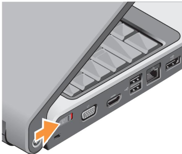
Per attivare lo switch wireless, farlo scorrere dalla parte posteriore alla parte anteriore del computer finché scatta in posizione.
