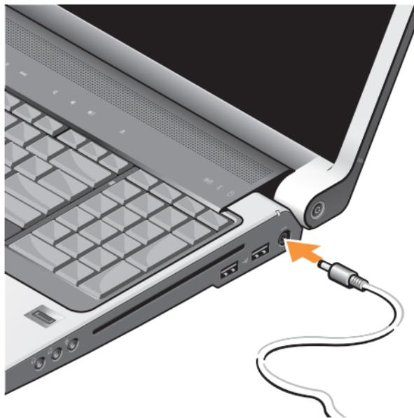
**⚠ ATTENZIONE:** L'adattatore c.a. è compatibile con le prese elettriche di qualsiasi Paese. I connettori di alimentazione, tuttavia, e le ciabatte variano da Paese a Paese. L'uso di un cavo incompatibile o il collegamento non corretto di un cavo ad una ciabatta o ad una presa elettrica potrebbe provocare incendi o danni all'apparecchiatura.
